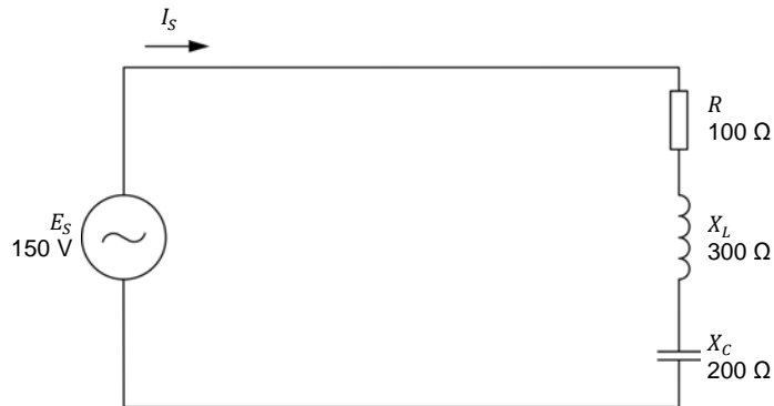
Figure 4-4. Circuit ca en série contenant une résistance, une bobine et un condensateur.
