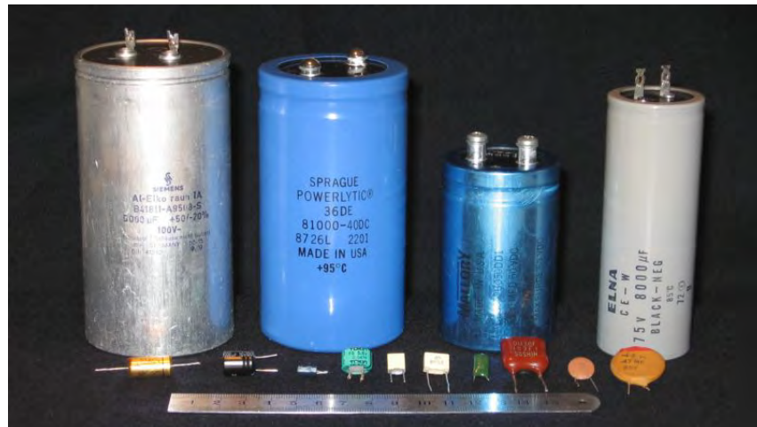
Figure 2-2. Divers types de condensateurs.
